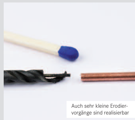
Erodierprinzip eines abgebrochenen Bohrers bzw. Gewindeschneiders
